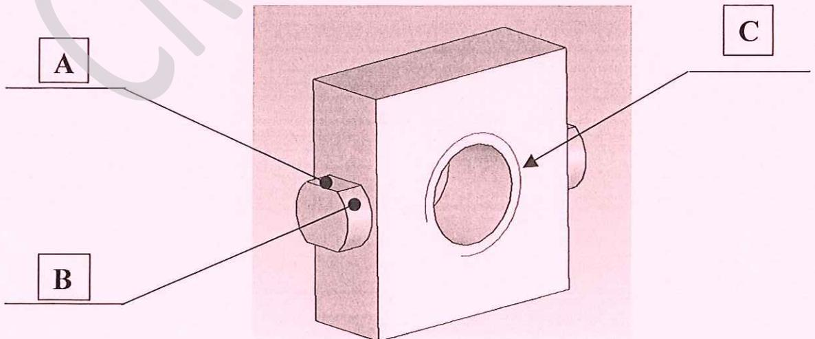
A : PLANE      B : CYLINDRIQUE DE REVOLUTION      C : HELICOIDALE
